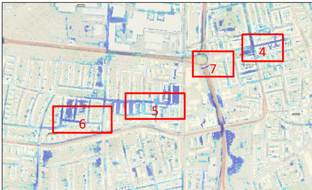
Abbildung 3: Überflutungskarte für einen 50-jährlichen Modellregen mit markierten Problembereichen und Gegenmaßnahmen in der Wissensbasis.
