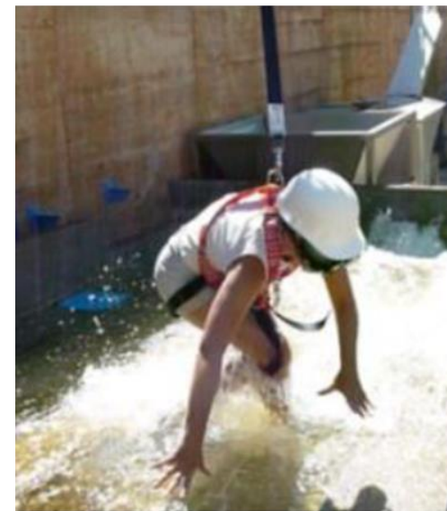
Experiment zur Ermittlung von Stabilitätskriterien für Fußgänger (Martínez-Gomariz et al., 2018)
