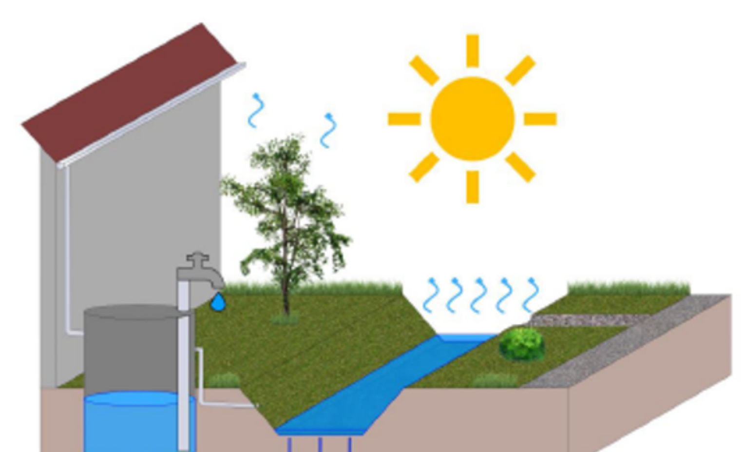
Abb. 4: Versickerungsmulde mit (Retentions-)Zisterne (© RPTU AMAREX)
